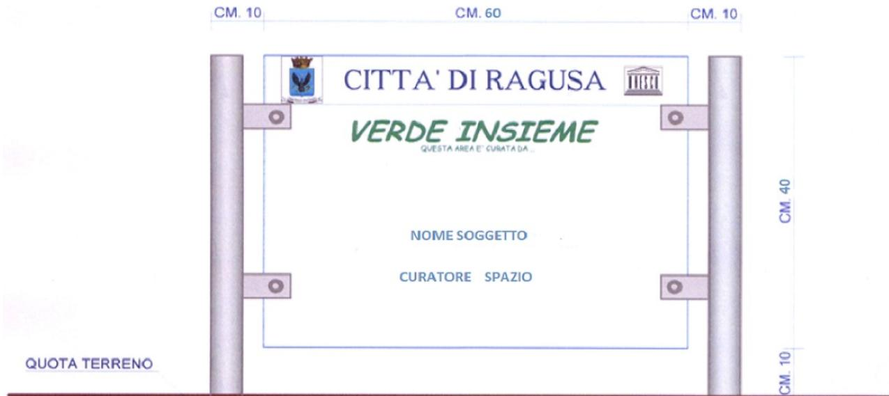
STRUTTURA DA REALIZZARE CON TUBOLARI IN ACCIAIO SATINATO Ø 6 cm.
