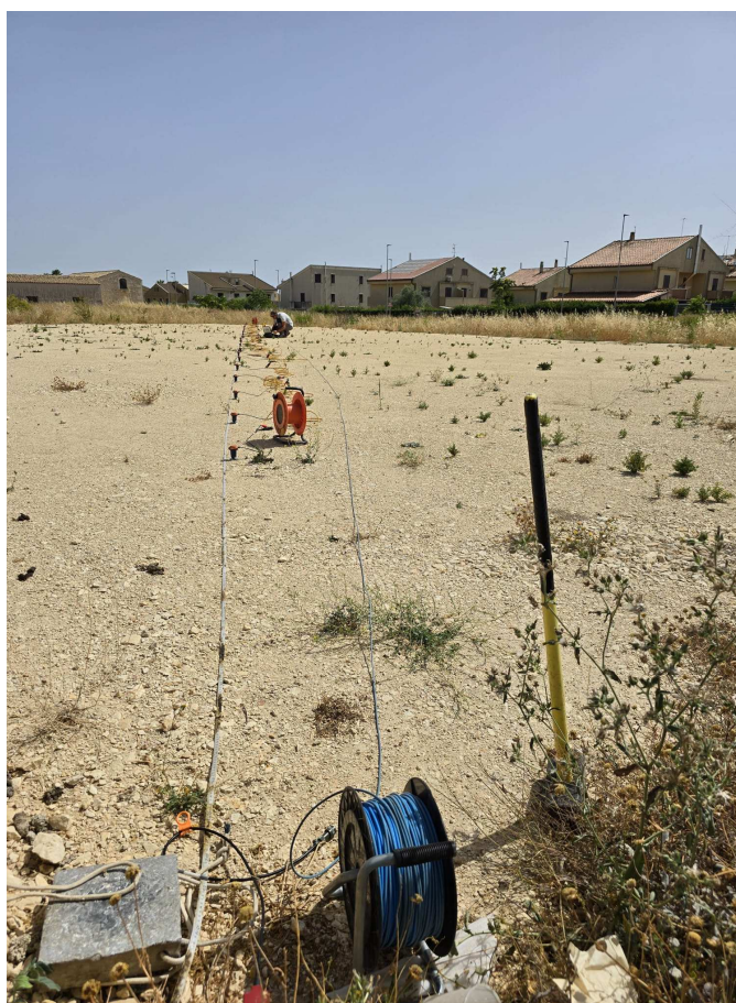
Indagine di sismica attiva metodologia M.A.S.W.
